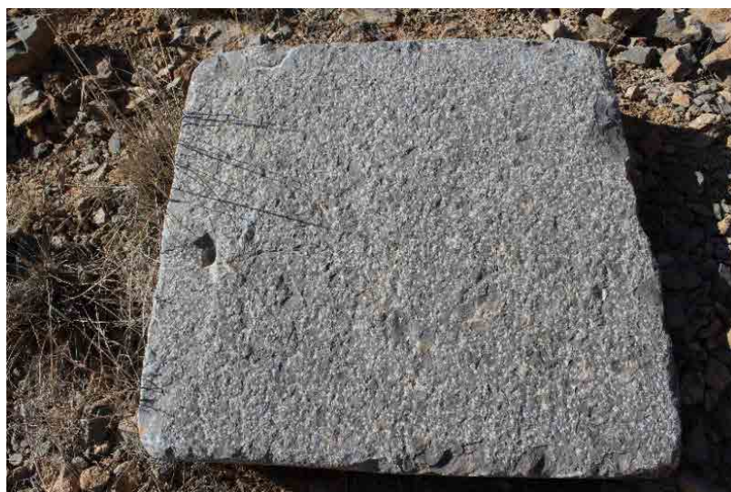
شکل ۳۷. بلوک سنگی چهارگوش و تراش و هموار کردن روی آن با ابزار پتک نوک‌تیز (کرمی، ۱۳۹۹).
