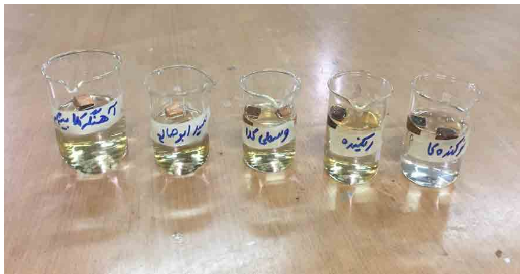
تصویر ۴: غوطه‌وری نمونه‌های چوبی استخراج‌شده از سقانفارها در آب مقطر و طلایی شدن آب در برخی از آن‌ها (نگارنگان، ۱۴۰۰). Fig. 4: Immersion of wooden samples taken from Saqanefars in distilled water and turning the water to golden color in some of them (Authors, 2020).
