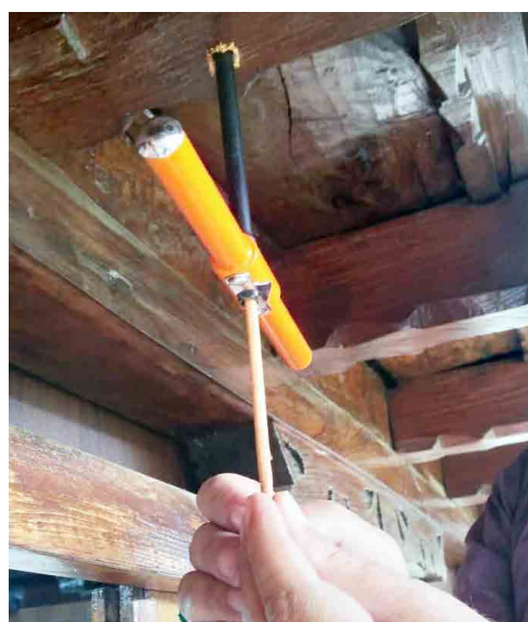
تصویر ۳: نمونه برداری غیرمخرب از ستون چوبی سقانهفار با استفاده از مت‌رویش سنج (نگارندگان، ۱۴۰۰). Fig. 3. Non-destructive sampling of Saqanefar wooden pole using an increment borer (Authors, 2020).
