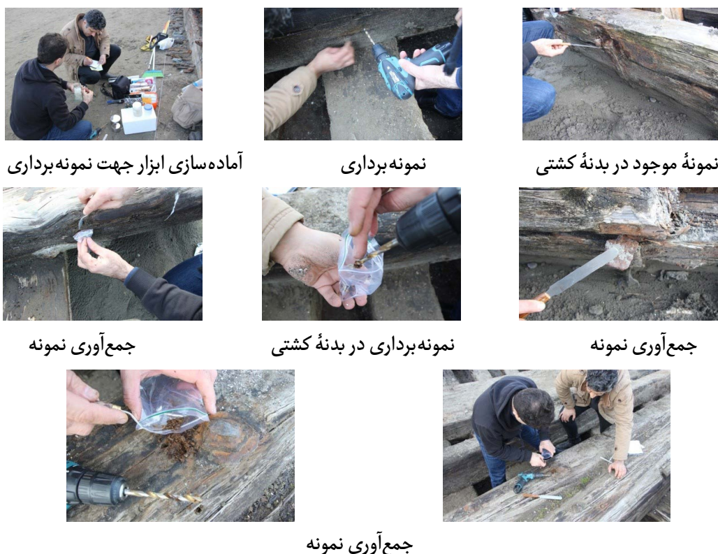
تصویر ۳. مراحل نمونه برداری، تعیین محل‌های نمونه‌گیری در بدنه کشتی، به همراه تجهیزات لازم در حین انجام کار (نگارندگان، ۱۳۹۸).
