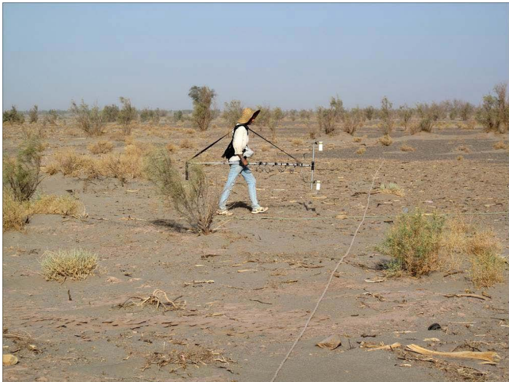
تصویر ۵. نحوه بررسی مغناطیس‌سنجی با دستگاه مغناطیس‌سنج سزیم (نگارنده، ۱۳۹۹).
