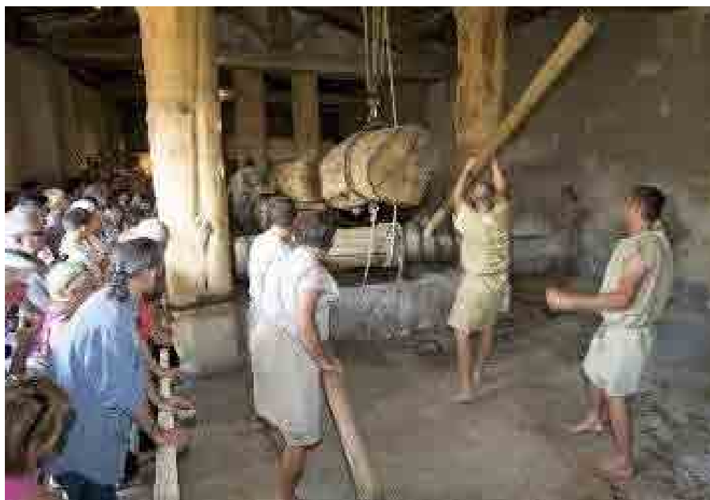
تصویر ۴. بازسازی دستگاه اهرم و ضرب در بوکر فرانسه (Burton & Tamara, 2019: 555).
