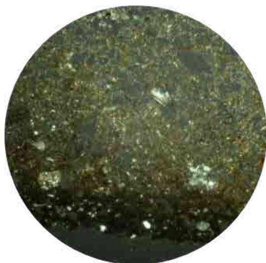
تصویر ۱۹. تصویر میکروسکوپی نمونه شماره ۵، بزرگ‌نمایی 4X، نور XPL، بافت سیلتی و تفاوت در رنگ حاشیه (نگارندگان، ۱۳۹۹).
