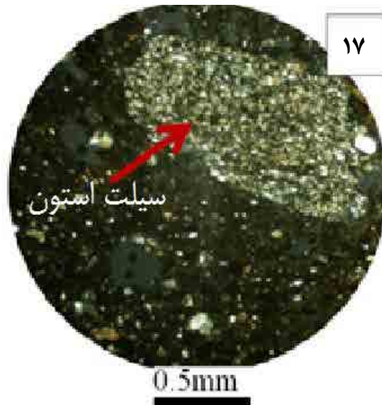
تصویر ۱۷. تصویر میکروسکوپی نمونه شماره ۲ مفرغ میانی، بزرگ‌نمایی ۴X، نور XPL، قطعه سنگ سیلت استون (نگارندگان، ۱۳۹۹).
