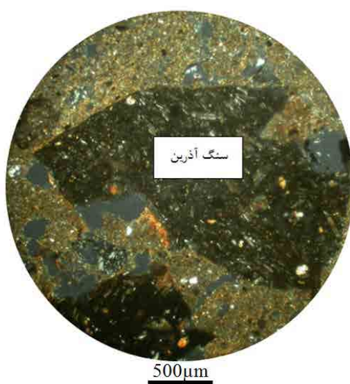
تصویر ۸. تصویر میکروسکوپی نمونه شماره ۷ کورا-ارس، نور XPL، طول میدان دید 2.7mm، بافت پورفیری، انواع مختلف قطعات درشت سنگ‌های آذرین بیرونی در زمینه سفال (نگارندگان، ۱۳۹۹).
