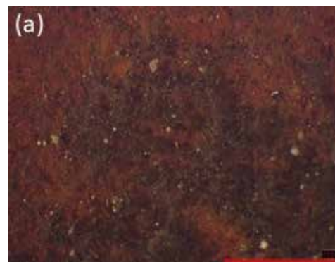
شکل ۱. مشاهده سه‌بعدی و میکروسکوپی سطح آجر تیمار شده با روغن بذر کتان پس از چرخه‌های ذوب و انجماد (Stefanidou & Karozou, 2016).
