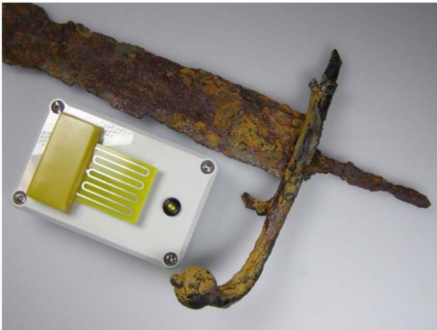
شکل ۱۱. حسگر CORRLOG جهت پایش خوردگی در آثار فلزی (Bacci et al., 2008).
