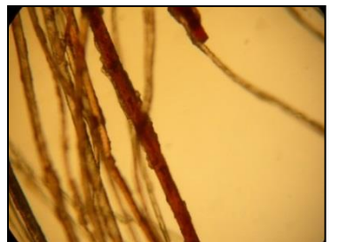
شکل ۱۰: تصویر میکروسکوپی نمونه‌ی شماره چهار با نور معمولی و شناسایی لیف پشم
