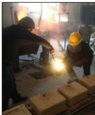
شکل ۷. مراحل مرمت خردگی‌های مجسمه نادرشاه افشار (منبع: نیعی طرئی ۱۴۰۰)
