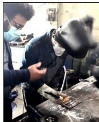
شکل ۷. مراحل مرمت خردگی‌های مجسمه نادرشاه افشار (منبع: نیعی طرئی ۱۴۰۰)
