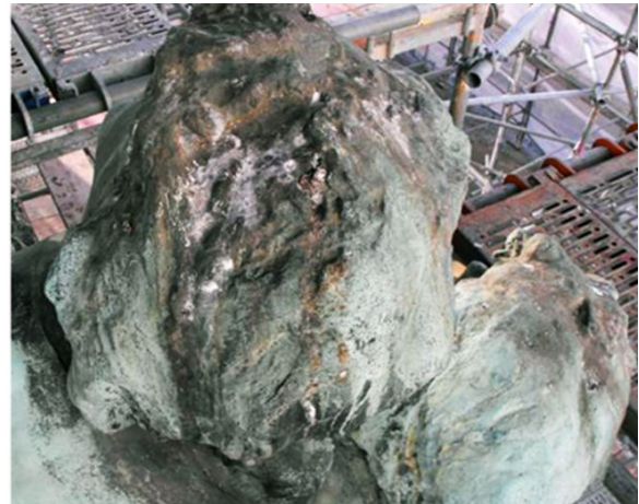
شکل ۱. تخریب منظر و ساختار مجسمه های شهری بر اثر فضولات پرندگان در شهر پراگ عکس از کاترین کریسلوا، ۲۰۱۷
