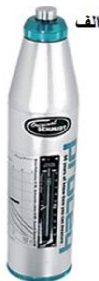
شکل ۲. چکش اشمیت نوع L استفاده شده؛ (ب) اندازه‌گیری سختی واجهشی با چکش اشمیت روی سطوح هوازده کندوان.
