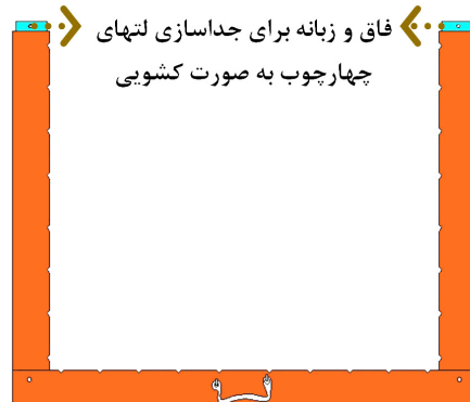
مرحله اول، برداشتن قسمت بالای چهارچوب و قرار دادن چهارچوب در مکانی ثابت
