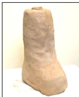
تصویر ۱۳. نمونه ساخته‌شده با پرکننده ماسه و مفتول پخته‌شده (مأخذ: نگارنده).
