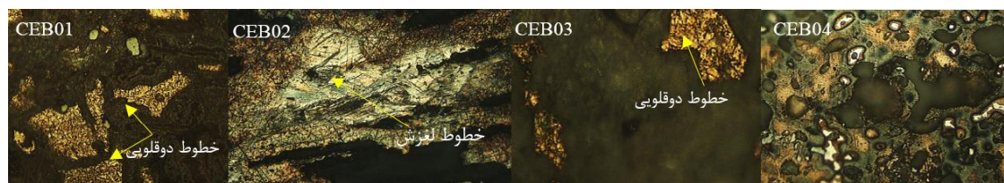
شکل ۵. تصاویر متالوگرافی بعد از اچ مربوط به نمونه‌های مورد مطالعه
