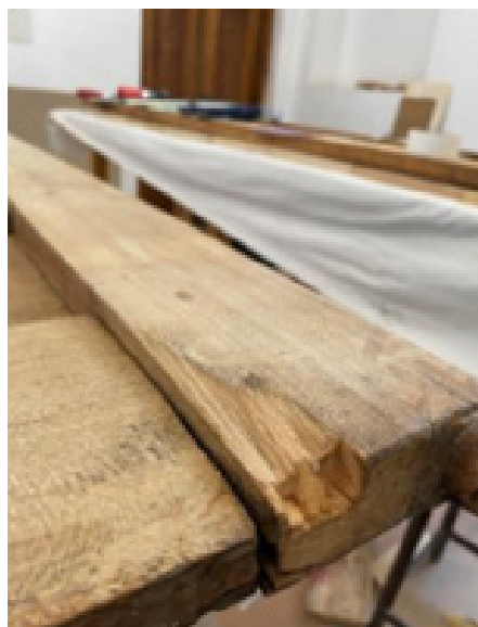
شکل ۷. نمونه‌برداری جهت سنجش اسیدیته از قسمت مشخص شده
