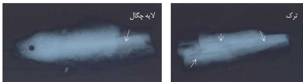
شکل ۶. عکس رادیوگرافی از اثر با انرژی 90 kV و شدت 5 mA در زمان ۵ دقیقه.
