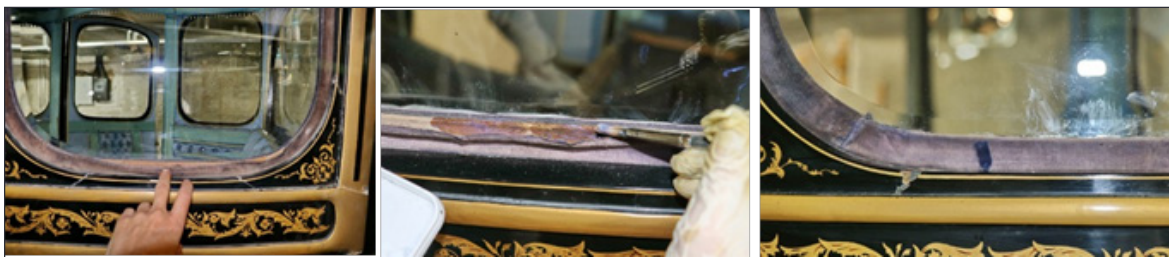
شکل ۱۶. پاکسازی و بازگرداندن نوارهای پارچه‌ای اطراف پنجره‌ها.
