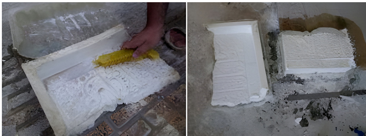
شکل ۱۱. درآوردن قالب و پس قالب از روی مدل، شستشو با آب و صابون و گذاشتن قالب سیلیکونی در داخل پس قالب
