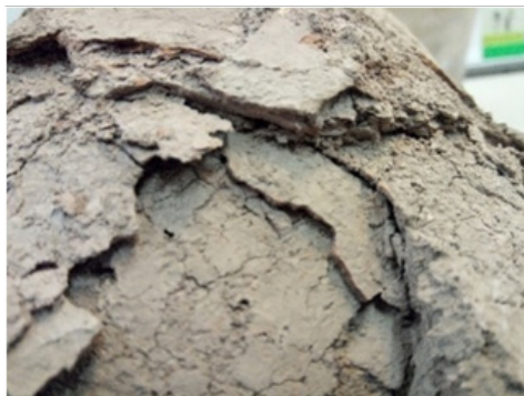
شکل ۱۰. از راست به چپ: لایه رسوبات تشکیل شده در سطح اثر. نفوذ رسوبات بین لایه ها و ایجاد آسیب بر اثر نوسانات محیطی.
