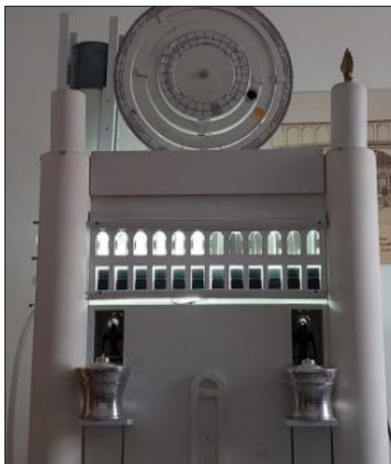
شکل ۹. آزمون نمایش نور در خانه‌های ساعت برای نمایش ساعات شب
