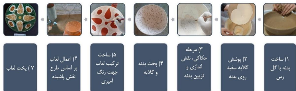
شکل ۲۱. مراحل ساخت سفال لعاب پاشیده.
