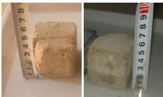
شکل ۸. از راست به چپ: آزمون موینگی نمونه شاهد قبل از نانو کردن، نمونه شاهد بعد از نانو کردن (مشکین‌فام‌فرد، ۱۴۰۰).
