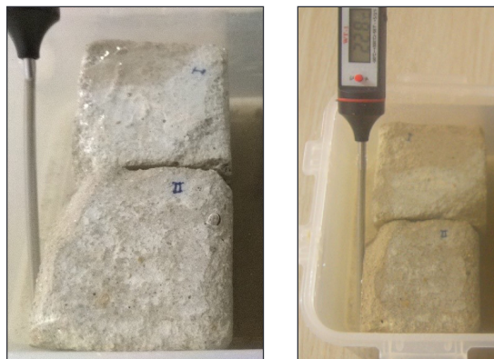
شکل ۹. از راست به چپ: نمونه شاهد قبل از اعمال مواد نانو، نمونه شاهد بعد از اعمال مواد نانو در ظرف آب دیونیزه (مشکین‌فام‌فرد، ۱۴۰۰).
